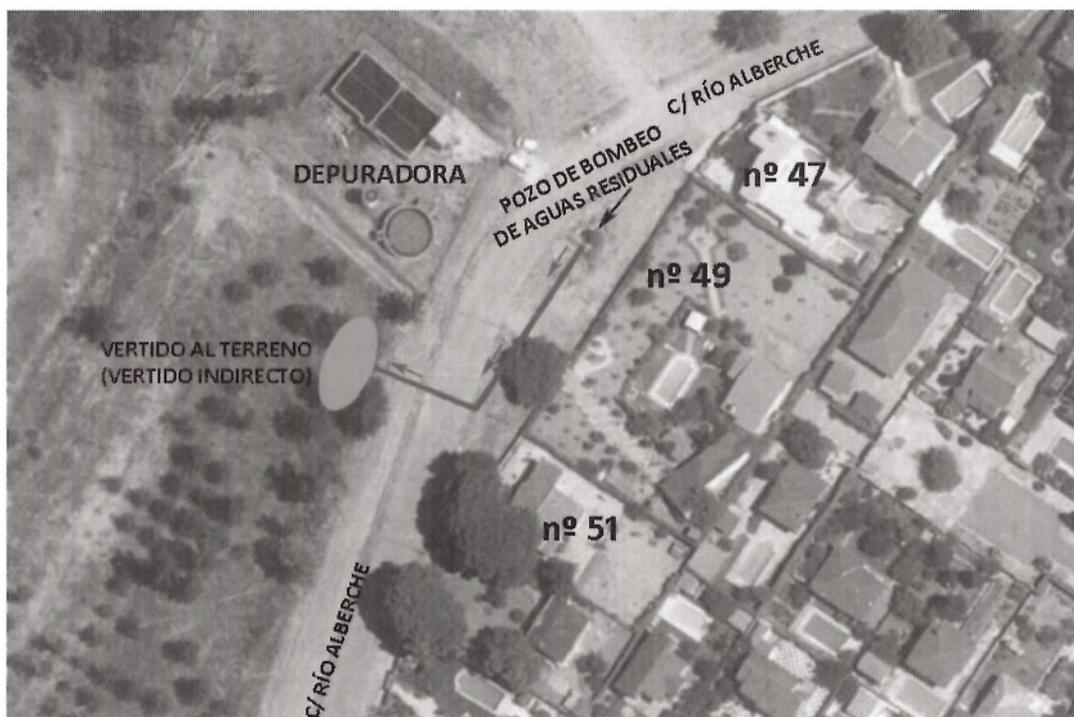
**FOTOGRAFÍA nº 1: RECORRIDO DE LAS AGUAS RESIDUALES CUANDO SE PRODUCE ATASCO DE LA BOMBA.**
